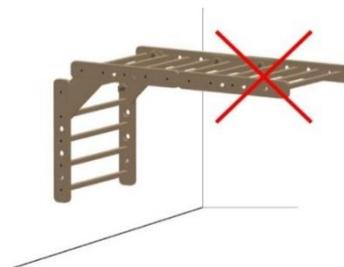
Mit der Reckstütze kann beim T2 die Traglast auf 70 kg erhöht werden.
