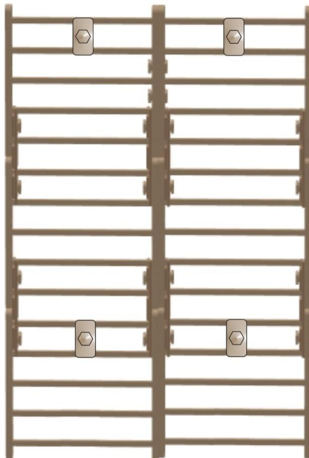
Abbildung 26 Platzierung der W1 bei nebeneinander verbundenen Bauplatten
