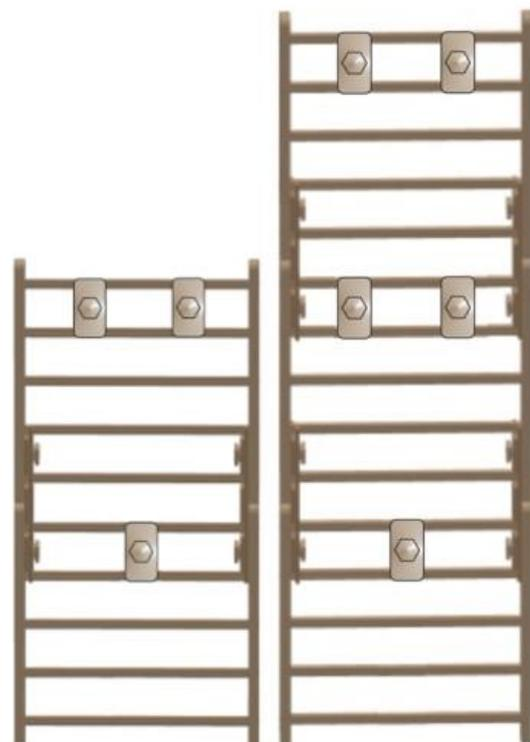
Abbildung 24 Platzierung der Wandhalterungen bei einer Bauhöhe von 2 und 3 Bauplatten
