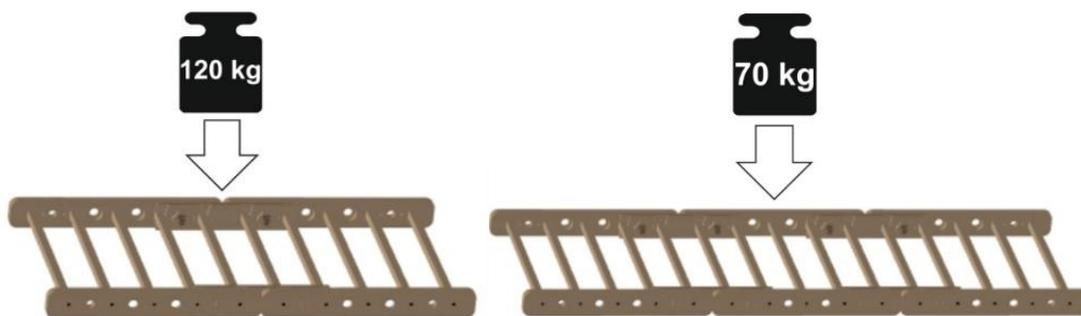
Für längere Konstruktion müssen nach jeder 3. Bauplatte eine Stütze eingebaut werden:
