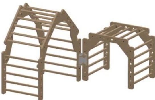
Abbildung 14 Montagebeispiel des Eckverbinders C1
