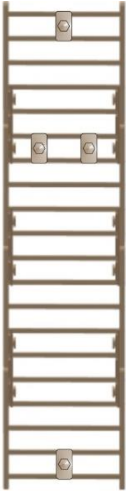
Bild 4 Platzierung der W1 bei einer Bauhöhe von 4 Bauplatten
