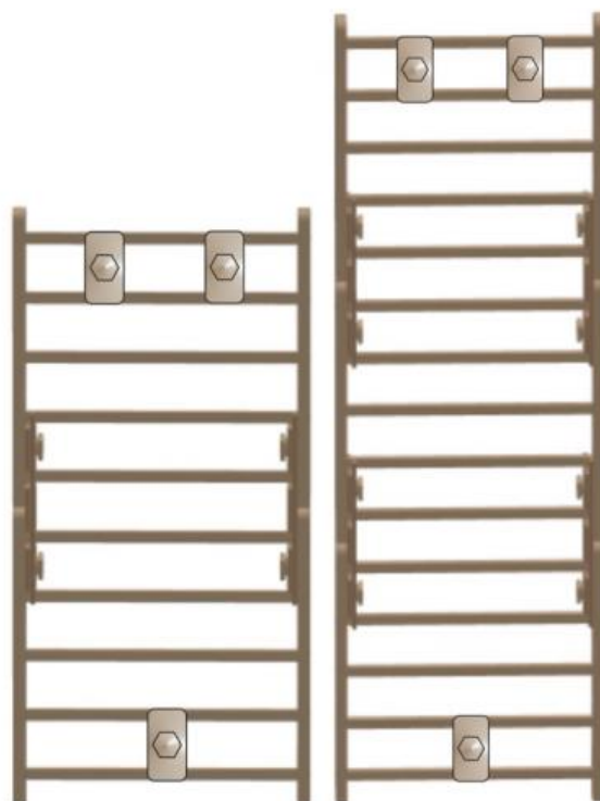
Bild 3 Platzierung der Wandhalterungen bei einer Bauhöhe von 2 und 3 Bauplatten
