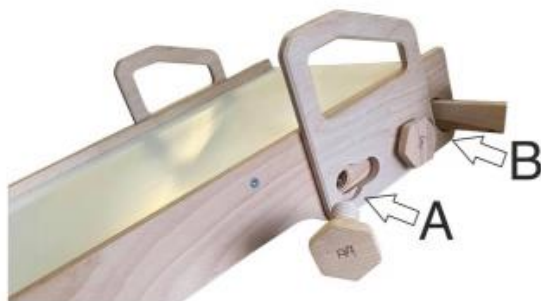
Abbildung 12 Montage der Rutschbahnhalter M1
