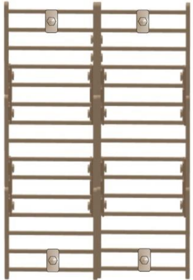
Bild 5 Platzierung der W1 bei nebeneinander verbundenen Bauplatten
